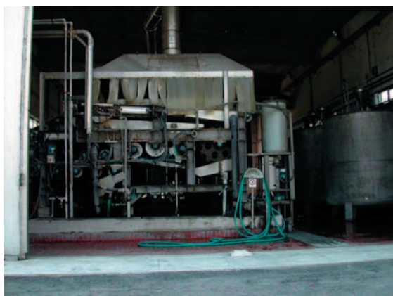
Figura 4: disidratazione dei fanghi.
